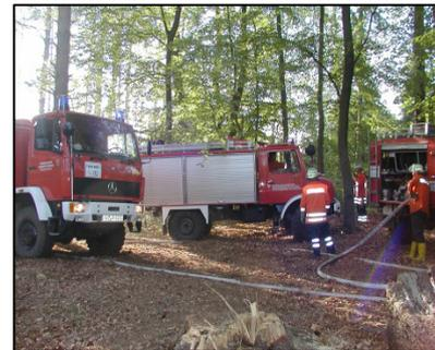
Schlauchwechselwagen der Feuerwehrtechnischen Einsatzzentrale in Hittfeld.
